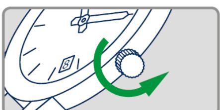
Per fare ripartire il meccanismo del vostro orologio e mettere l'orario desiderato , questo specifico movimento Chopard deve essere caricato manualmente girando la corona in senso ANTIORARIO finchè l'orologio non parte. Per assicurare un'ottimale ricarica e funzione del movimento un automatico deve essere usato quotidianamente.
