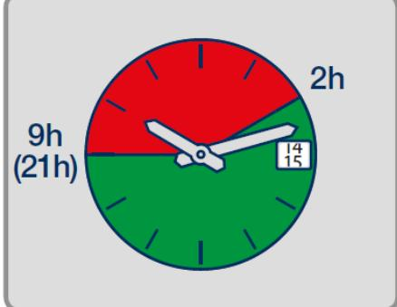
Per evitare di danneggiare il meccanismo della funzione della data NON usare la rimessa rapida quando le lancette sono fra le 9 PM e le 2 AM.
