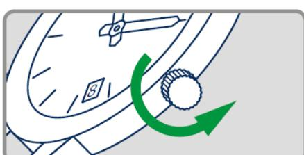
Para reiniciar el mecanismo y puesta en hora, en este especial movimiento Chopard, debe remontarse de manera manual girando la corona en sentido contrario a las agujas de reloj. Para asegurar un óptimo funcionamiento del movimiento, mediante la cuerda automática, debe ser utilizado a diario.
