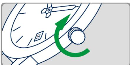
Para reiniciar el mecanismo y puesta en hora, el movimiento debe remontarse de manera manual girando la corona en sentido a las agujas de reloj. Para asegurar un óptimo funcionamiento del movimiento, mediante la cuerda automática, debe ser utilizado a diario.
