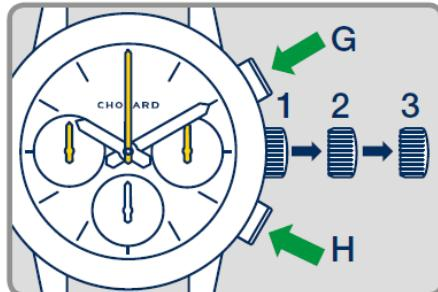
Para el ajuste de las agujas del cronógrafo a Zero, tire de la corona a la **posición 2 ó 3** y active los pulsadores G o H según corresponda
