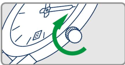
Para reiniciar el mecanismo y puesta en hora, el movimiento debe remontarse manualmente girando la corona en sentido a las agujas de reloj. Para asegurar un óptimo funcionamiento del movimiento, debe ser remontado de forma manual diariamente.
