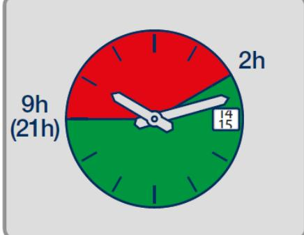
Para evitar daños en el funcionamiento del mecanismo, el ajuste de fecha **NO** debe ser realizado entre las 09:00 PM & 02:00 AM.
